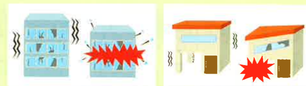
壁が少ない階のあるビル 1階がほとんど柱だけの住宅
