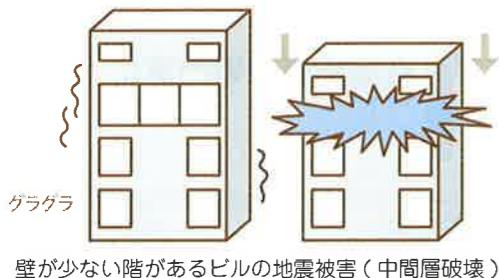
壁が少ない階があるビルの地震被害（中間層破壊）
