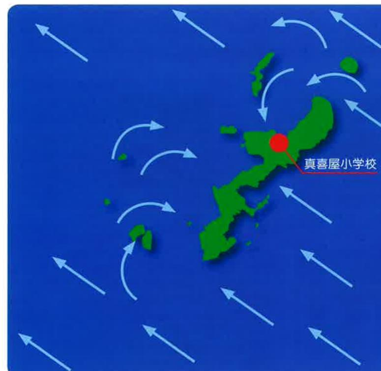
左図のように津波は障害物の裏に回り込んで進んでいくという性質があり、波の回折（かいせつ）と言います。回折により、津波発生源から陸を介した反対側にも津波が押し寄せた事例が昭和35年のチリ地震津波です。
