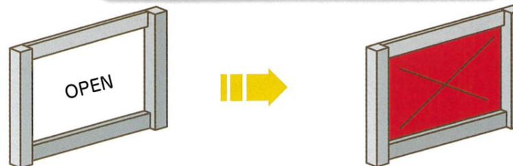
ピロティの場合、壁を新たに増設か、鉄骨ブレースを入れることで、建物の強さを改善する。
