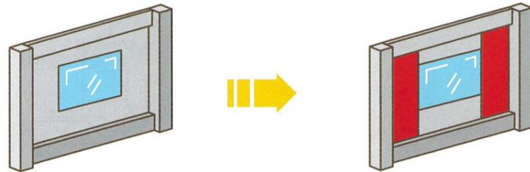
柱際に壁がある場合、柱際の壁に新たな壁を打ち増すことで、建物の強さをさらに強くする。
