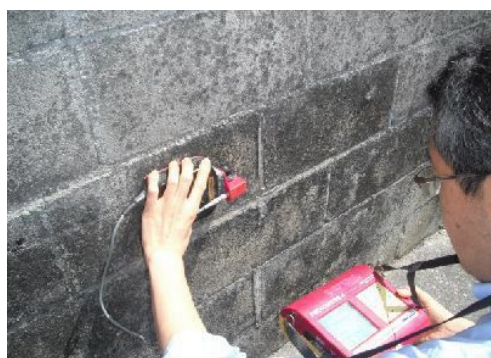
鉄筋の磁気探査機(約100万円)による探査 機器は富士物産のPROFOMETER 4 S型
