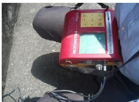
鉄筋の位置と深さを探知可能 ピッチも被りも正確に測定できる が、今回の目的にはオーバークオリティでDIYでは使えない。レンタルもあるが、県内は運送に時間がかかる。
