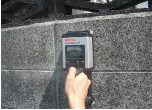
粗密探査機(約10万円)による探査
